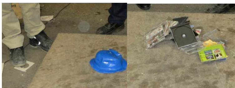
Ilustración 3.- Parte de la muestra de PS de la fracción de Plástico no Envase a la entrada en planta.
