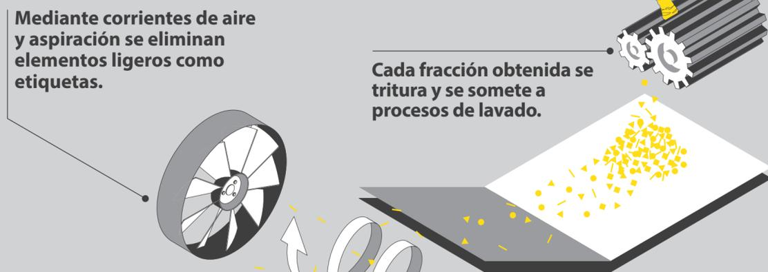
Mediante corrientes de aire y aspiración se eliminan elementos ligeros como etiquetas.
