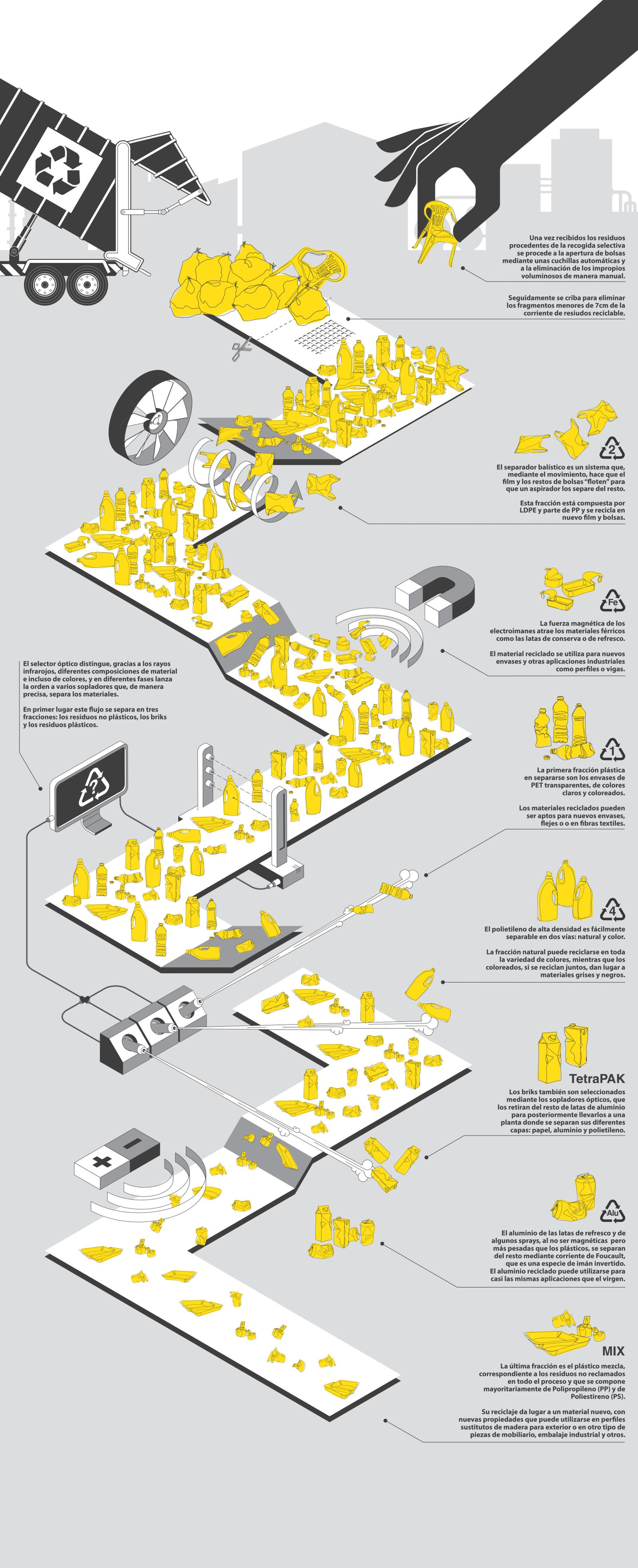
Una vez recibidos los residuos procedentes de la recogida selectiva se procede a la apertura de bolsas mediante unas cuchillas automáticas y a la eliminación de los improprios voluminosos de manera manual.
